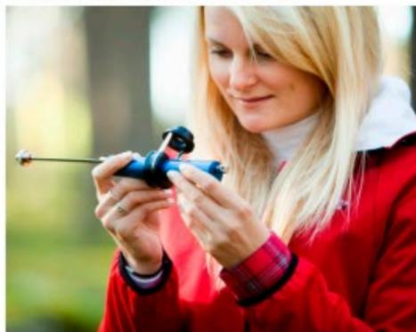
Las barrenas de Haglöf Sweden se usan para determinar el incremento, la edad y la calidad de los árboles. Un testigo de madera extraído ofrece detalles sobre la edad y el incremento del árbol, sobre el clima, la fertilización, la tasa de crecimiento, el suministro de agua, los incendios, los daños y las enfermedades anteriores. El testigo es una ayuda va-
