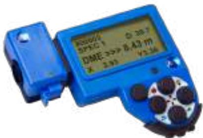
El DP DME GPS ofrece todas las funciones que tienen el DP DME y el DP GPS combinadas en un solo módulo.
